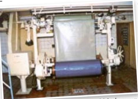
Das mit der lichtempfindlichen Schicht begossene Trägermaterial muss jetzt noch auf der Filmschneidemaschine in die gängigen Formate geschnitten werden.
